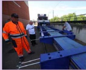
La remorque créée sur mesure est extensible jusqu'à 33 mètres de longueur utile pour le plateau de chargement. Photo L'Alsace
